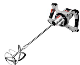
Подбор частоты вращения: при погружении миксера на дно тары по центру, на поверхности материала должна образоваться воронка глубиной 1/4 -1/5 от общего уровня материала, весь объем материала должен участвовать в движении. Ориентировочная частота вращения:
